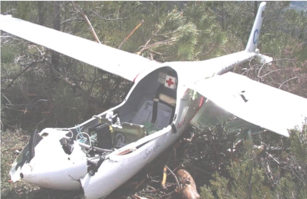
Canopy, estabilizador horizontal, leme de profundidade, *aileron* da asa direita arrancados; ambas as asas danificadas até à longarina; também a célula de protecção do cockpit absorveu grande parte da energia do impacto, salvando o piloto – tudo provas da excelência de construção do moderno planador de fibra.
