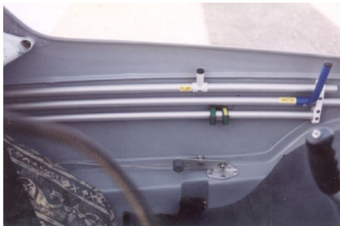
Fig. 8: *flap*, freios, trim, trinco das portas do motor.
