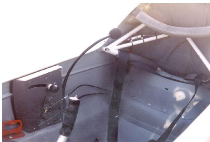
Fig. 9: ejeção da *canopy* e caixa dos controlos de accionamento do pilão do motor/hélice.
