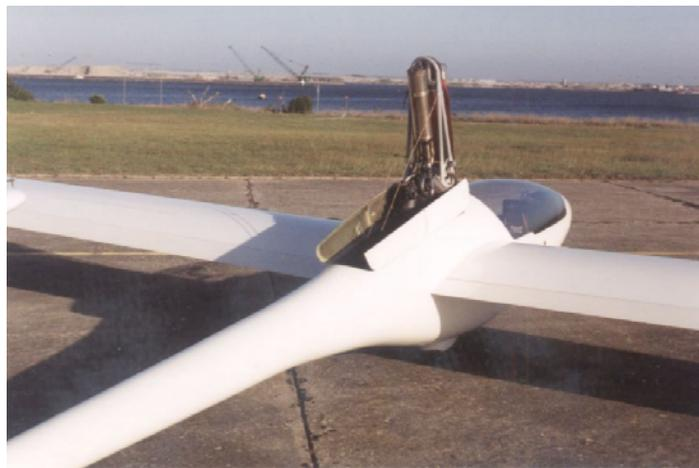
Fig. 3: o discreto dimensionamento da abertura das portas do motor/hélice na fuselagem dos Silent.
